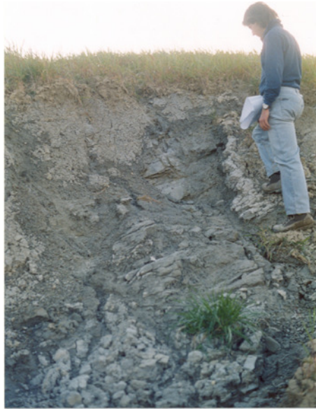
Fig. 1a – Affioramento ubicato a NE di Casa La Rotta (265m s.l.m.): ARGILLE SILTOSE GRIGIE (8) – Sedimenti argillosi di colore grigio organizzati in strati di spessore centimetrico e decimetrico, o sottilmente laminati.
