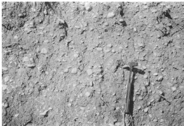
Fig. 8b - Affioramento ubicato a W del sondaggio 14 (285 m s.l.m.): DEPOSITO DI VERSANTE (3) - Particolare del pietrisco calcareo, eterometrico, costituito da clasti sub-angolosi e sub-arrotondati, immersi in matrice a prevalente componente terrosa e subordinatamente sabbiosa.
