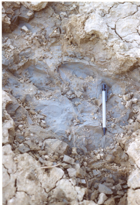
Fig. 5 – Affioramento ubicato ad E di San Bartolomeo (410 m s.l.m.): ARGILLE GRIGIO-AZZURRE (6) – Particolare del deposito argilloso di colore grigio – azzurro con tipica frattura concoide.
