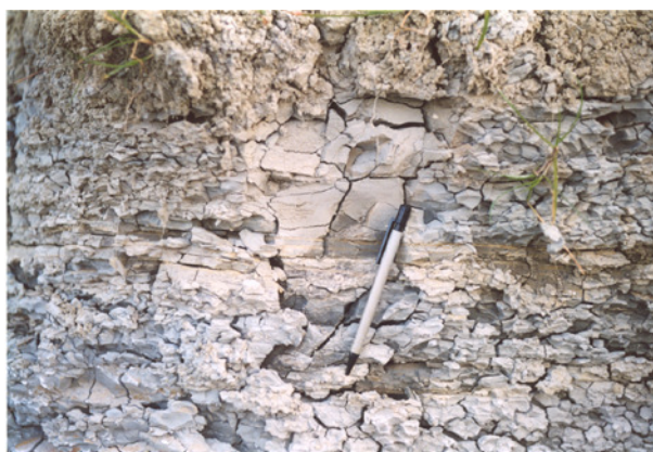
Fig. 2 – Affioramento ubicato a NE di Casa La Rotta (265m s.l.m.): ARGILLE SILTOSE GRIGIE (8) – Intercalazione di livelli millimetrici di sabbia fine di colore ocra nel deposito argilloso di colore grigio. S: N 60W,20NE.
